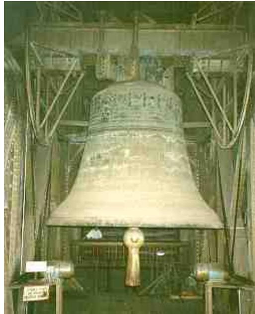
Höhe: 3,21 Meter, Durchmesser: 3,24 Meter, Gewicht: 24 Tonnen
