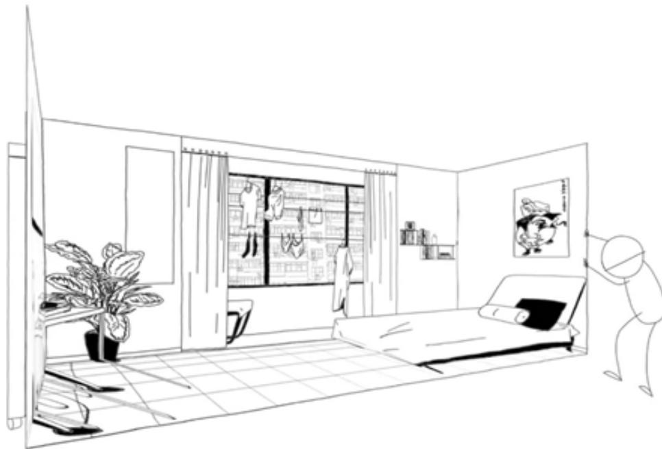
Außen auf der linken Kulissenwand wird die Rahmenkonstruktion sichtbar, die auf Lenkrollen läuft. Auf der Rückseite des ersten Bühnenraumes befindet sich symmetrisch angeordnet ein zweiter, der sich nun ins Bild dreht. Ein Kellerraum ist zu sehen mit einer mittigen Öffnung in der Rückwand, scheinbar dahinter eine Steinmauer. Die Ausstattungsgegenstände fügen sich aus der Anamorphose zu einem schlüssigen perspektivischen Raumeindruck, als die Drehung stoppt.
